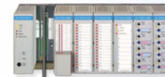
CPU-Modul wurde entfernt, Anbindung der verbleibenden AS-Hardware mittels Systemkabel mit Steckadapter
