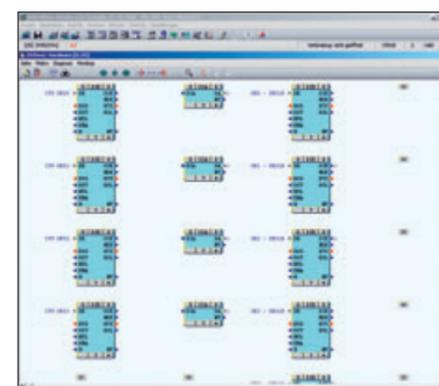
Der direkte Export aus WEBPROJECT an E-CAD-Systeme erledigt in wenigen Minuten die Erzeugung oder Revision von kompletten MSR-Stromlaufplänen. Auch die durchgängige Konfiguration und Beschriftung der Hard- und Softwaremodule der Automationssysteme erfolgt vollautomatisch.
